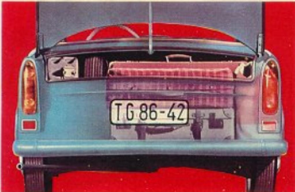
zádi TRABANTu 601. Vzduchem chlazený 600 ccm dvoudobý dvouválec, výkon 23 k, přenášený plně synchronizovanou čtyřstupňovou převodovkou na přední kola. Vynikající jízdní vlastnost a stabilita je docílena nezávislým zavěšením jednotlivých kol a dvěma přičními progresivními listovými pery.
