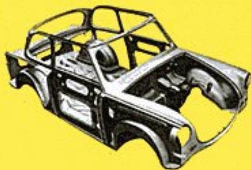
Die form-schöne, nach neuen internationalen Geschmackstendenzen entwickelte selbsttragende Ponton-Karosserie in flüssiger Linienführung bietet 4 erwachsenen Personen bequemen Platz. Das mit der Bodentragsplatte verschweißte Stahlblechgerippe zeichnet geringes Eigengewicht und erhöhte Stabilität aus. Die Außenhaut besteht aus dem nunmehr tausendfach beschützten und unter allen klimatischen Bedingungen erprobten Duroplast-Karosseriebaustoff.
